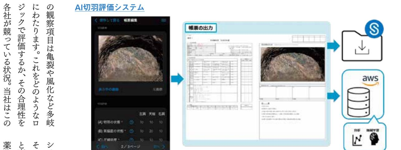
AIにより風化変質を可視化及び切羽評価した結果の比較例
