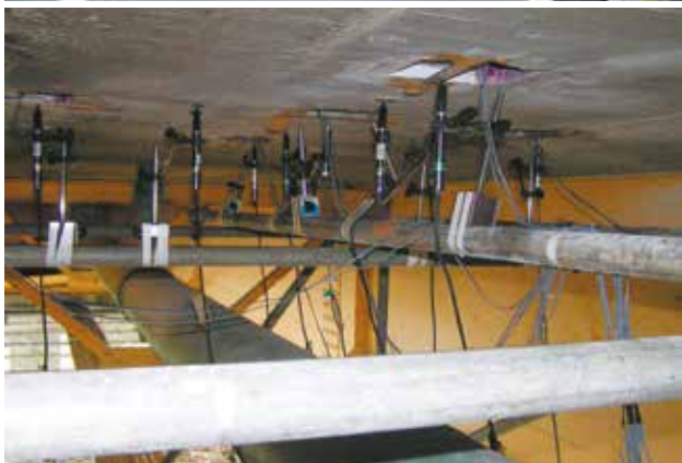
復旧後の追跡調査。床版載荷試験での載荷状況(上)と計測状況(下)
