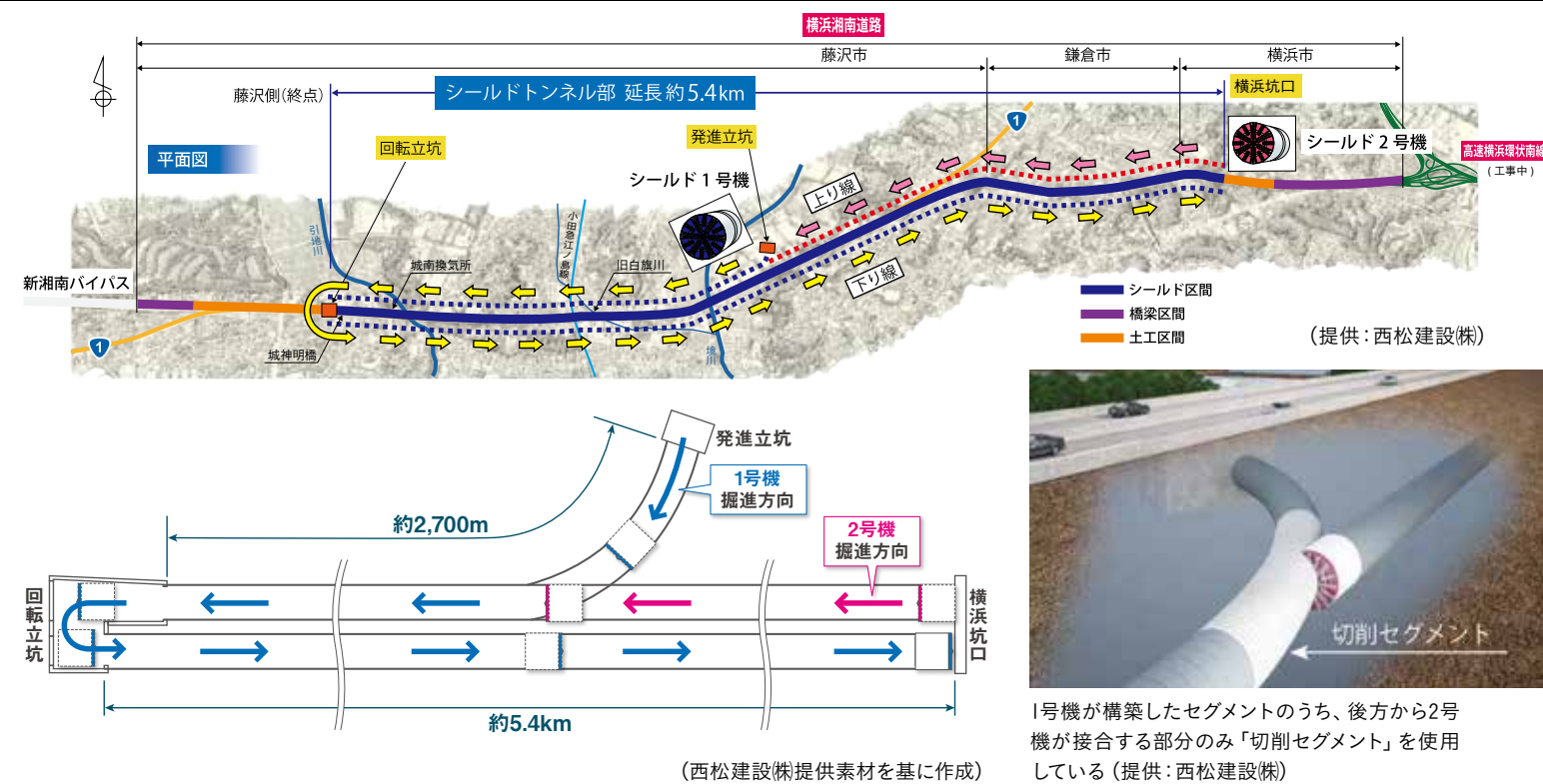
本線から少し離れた場所に立坑をつくり、そこから発進した1号機が曲線を描きながら本線直下に入って掘進。その曲線部に後方の「横浜坑口」から発進した2号機が接合して上り線のトンネルを構築した
