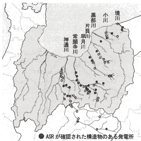
図-2.3.24 ASR の劣化マップ 6)
