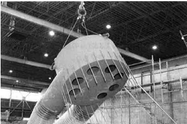
図-1.5.20 実験に用いた管の折返し部 42)
