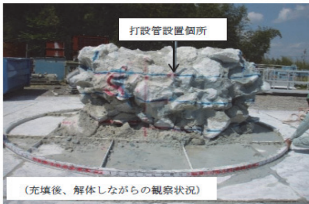
遮蔽壁構築用可塑性グラウトの充填状況
