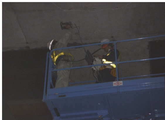
写真2 打音調査・診断システムの適用(頂版下面)
