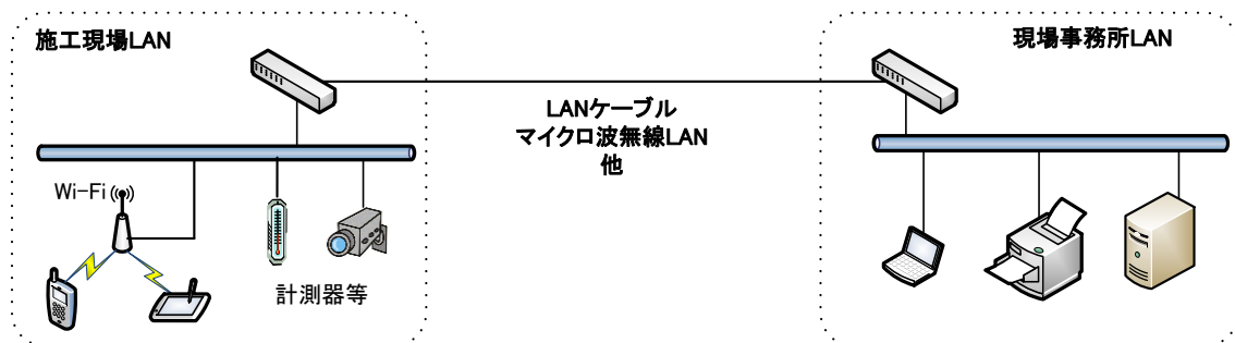
図 2-3 ケーブルの延長による接続
