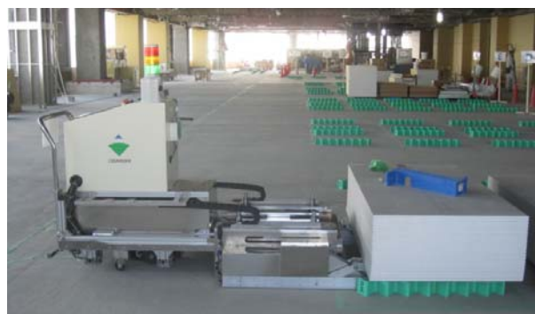
写真5 荷取位置での資材の積載
