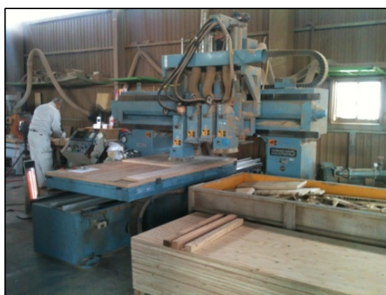
写 1 NCマシンによる型枠加工
