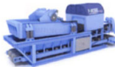
写真 6.11 土砂精密分離装置
