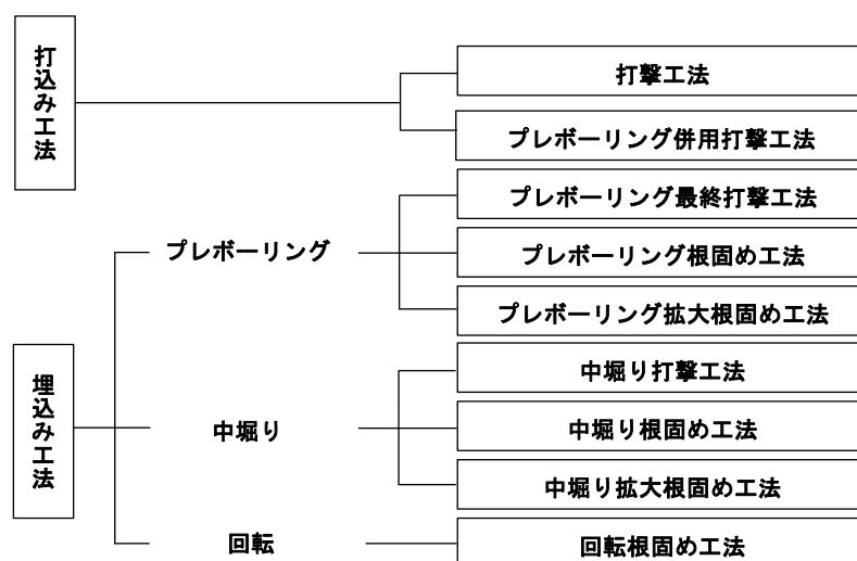
図 3.2.15 既製コンクリート杭の施工法の分類 35)
