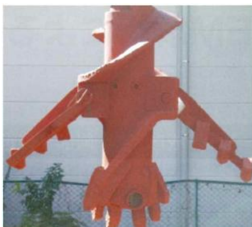
写真 3.2.11 拡大球根築造用掘削ビットの例 36)
