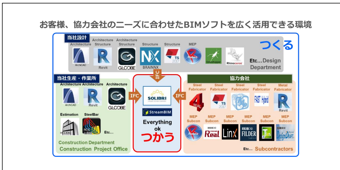
図 オープン BIM 方式による整合性の確認 (出典：竹中工務店)
