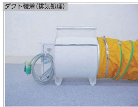
写真1 ポータブル集塵機<sup>1)</sup>
