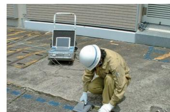
写真4 表層部対応型レーダーによる埋設物探査状況
