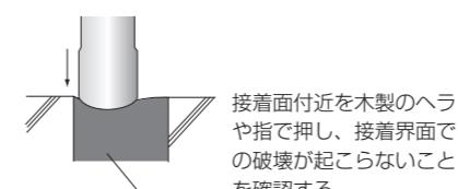
図3 指触による接着性試験<sup>1)</sup>
