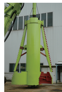
拡底バケツ (拡底部掘削中)
