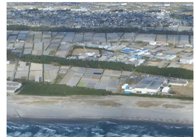
海岸の強風や飛砂、高潮や津波の被害を樹林帯で防止 11) (海岸防災林)
