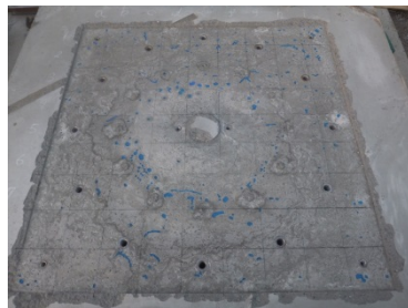
写真-7 充填性試験体(充填率 98.6%)
