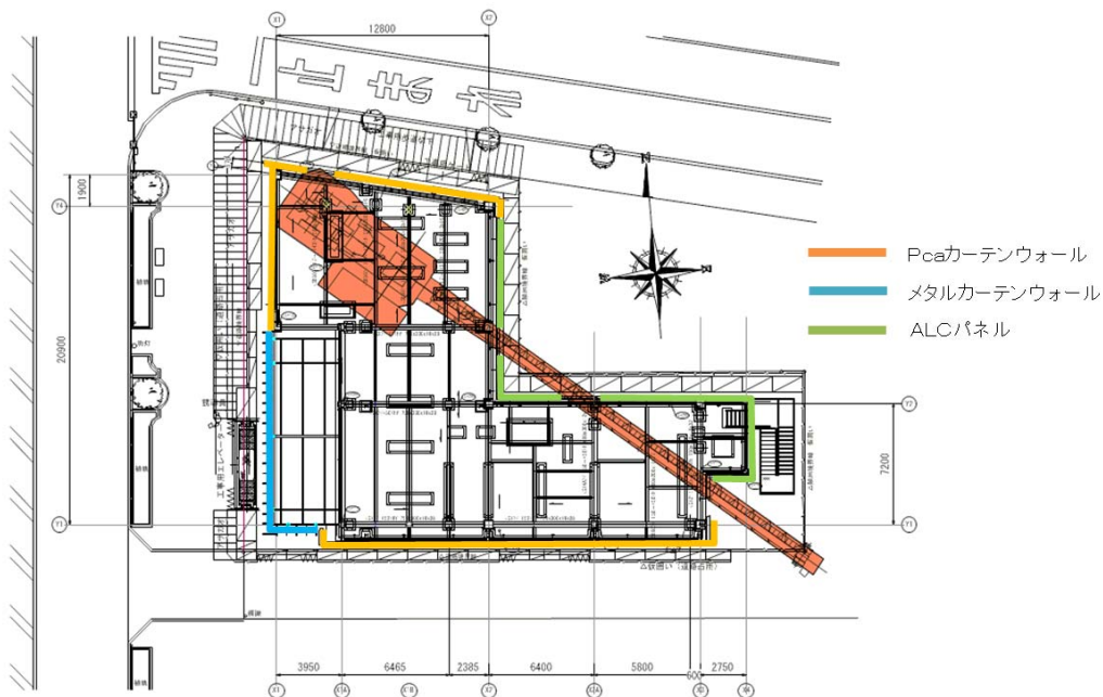
図-2 屋上クレーン（定置式）による計画 （作業半径30m×定格荷重5.0t）
