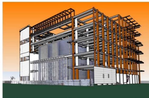
図4 既存棟データを取り込んだ3Dモデル
