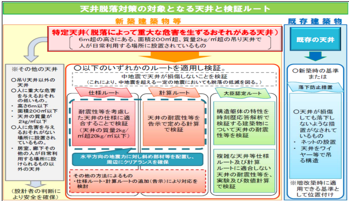
資料-3 天井脱落対策の対象となる天井と検証ルート (出典:国土交通省HPより)
