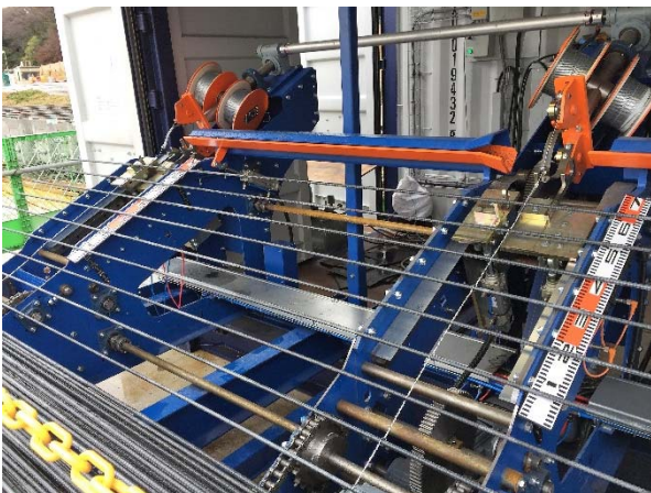
写真3. 13 亜鉛メッキ番線による自動配筋
