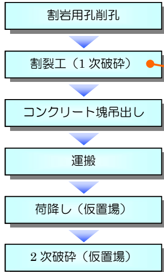
堆積コンクリート撤去フロー
