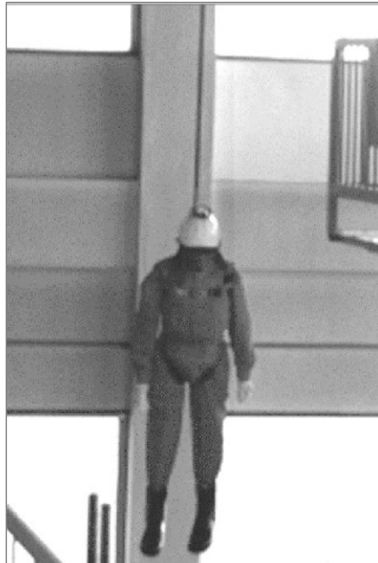
写真1-2 フルハーネス型の 墜落制止後の状態(例)
