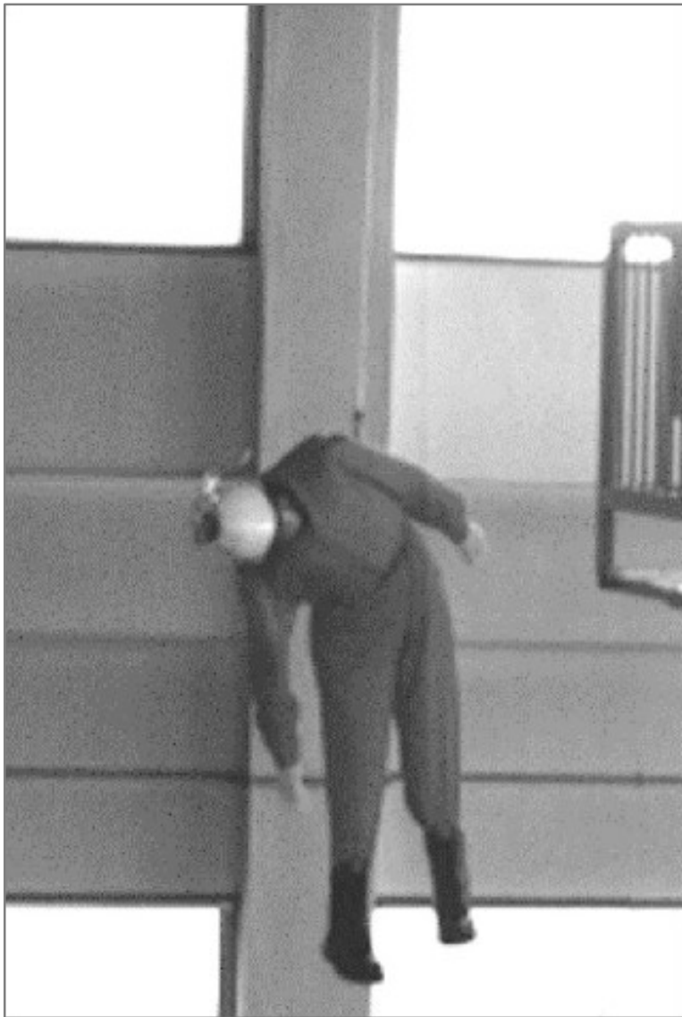
写真1-1 胴ベルト型の 墜落制止後の状態(例)
