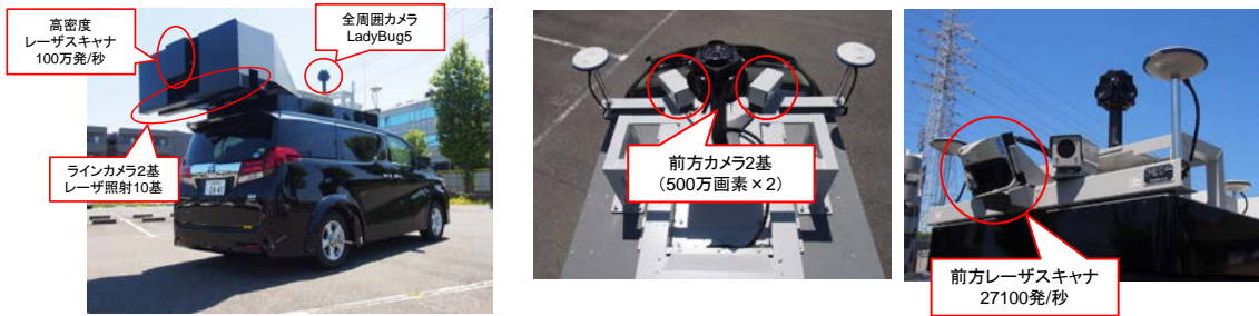
図-1 起工測量に使用したMMS(Mobile Mapping System)の装備概要
