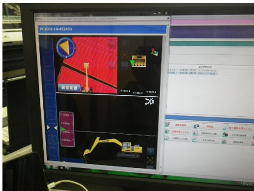
写真3 マシコントロール (画面：平面、断面)
