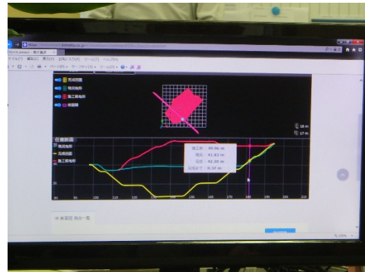
写真4 マシコントロール (画面：施工進捗断面)
