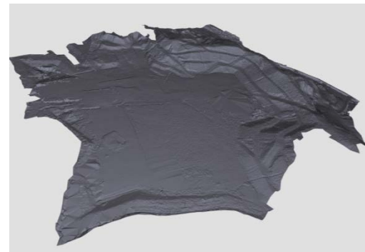
図-2 3Dスキャナ測量成果（切土部）
