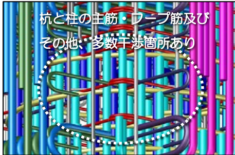
②鉄筋干渉箇所の確認
