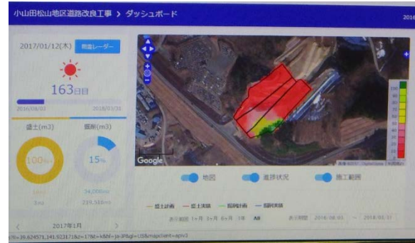
写真2 マシコントロール (画面：出来形管理)
