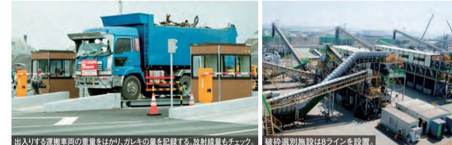
出入りする運搬車両の重量をはかり、ガレキの量を記録する。放射線量もチェック。
