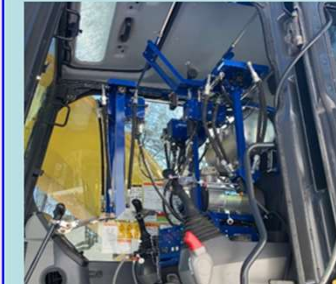
遠隔操作装置の設置状況
