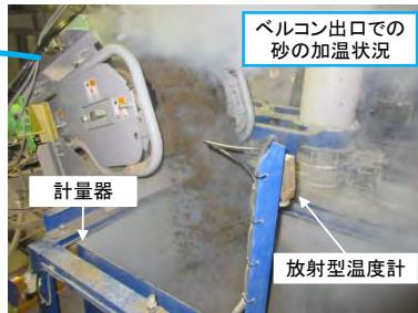
写真1 骨材の蒸気加温設備と加温状況
