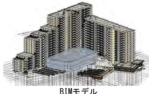
設計完了前の段階でチェックすることで、施工レベルの整合性が取れた BIM モデルを作成し、施工図・製作図を BIM モデルから生成した。また BIM モデルには敷地内埋設管・绿化計画も網羅し、外構工事の先行施工に伴う施工検討の効率化などに貢献している。
