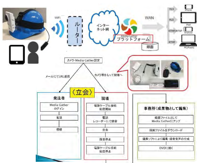
ネットワークカメラによる現場立会、確認検査
