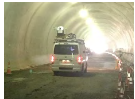
MMS による計測状況
