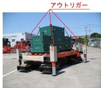
アウトリガージャッキを使用した曲線操舵機構
