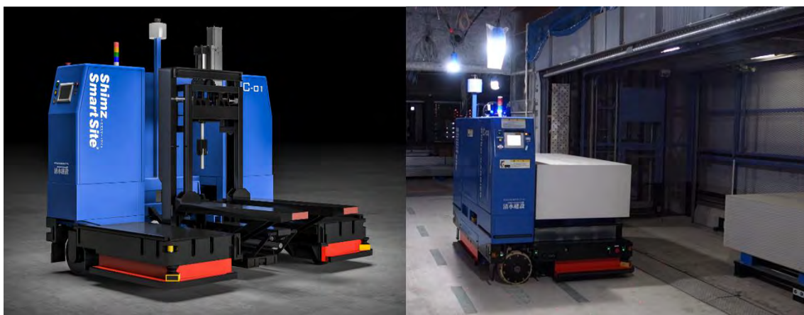
Robo-Carrier のイメージと新大阪の現場で稼働している様子
