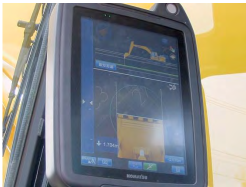
写真1 モニターによる杭芯確認
