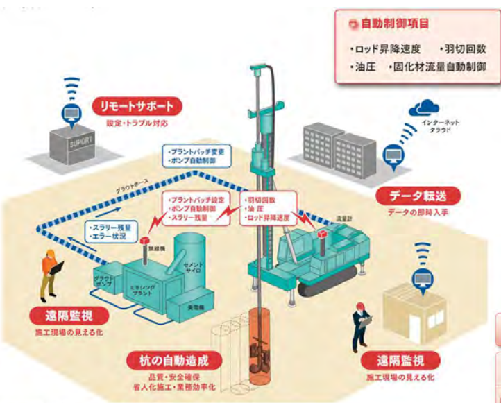
図-6 全自動施工管理システムの概要
