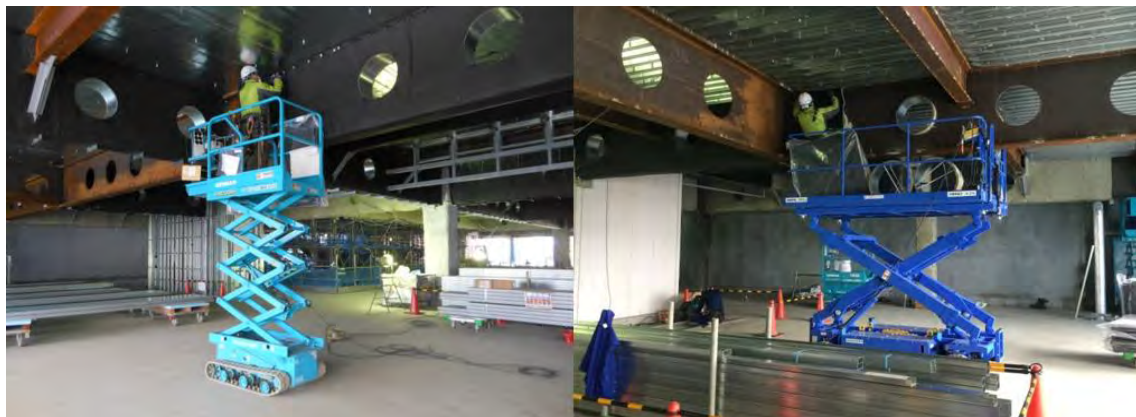
従来型の高所作業車（左）と拡幅型高所作業車
