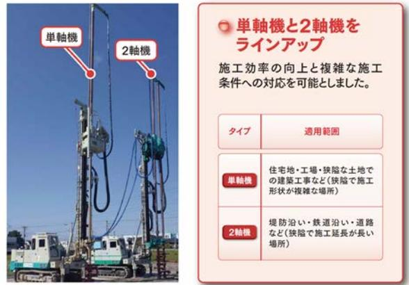
図4 施工機のタイプと適用範囲
