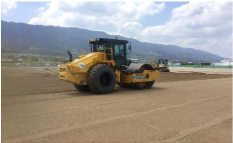
GNSS 搭載振動ローラ
