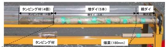
図3 模擬の爆薬での遠隔装填システムによる密装填状況
