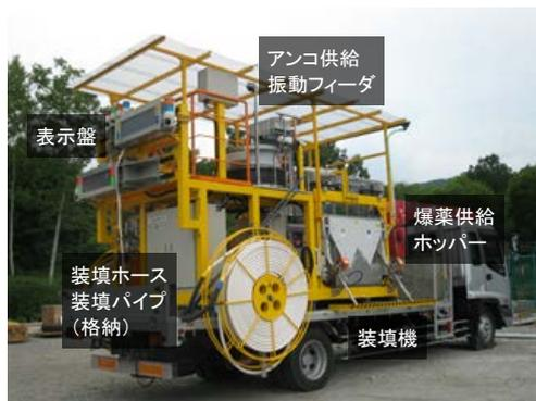
写真1 爆薬の遠隔装填システム
